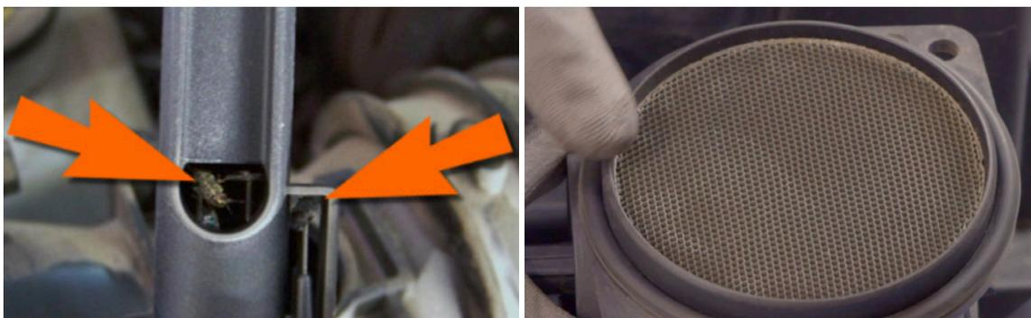
**WALKER PRODUCTS NO RECOMIENDA UTILIZAR AEROSOL LIMPIADOR PARA EL SENSOR MAF. PODRÍA DAÑAR EL SENSOR DE FLUJO DE MASA DE AIRE Y SUS COMPONENTES.**
