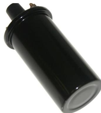
Las Bobinas de Encendido han pasado por varias evoluciones, pero su función esencialmente siempre ha sido la misma. Por lo tanto, ya sea que tenga un sistema de distribución, paquetes de bobinas controlados por un módulo o un sistema Coil On Plug administrado por ECU, el objetivo sigue siendo el mismo: tomar bajo voltaje, acumularlo y entregar alto voltaje a la bujía con precisión.
