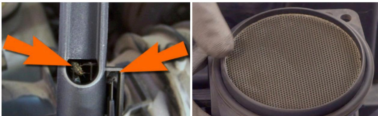
**WALKER PRODUCTS RACCOMANDA DI NON UTILIZZARE PULITORI SPRAY AD AEROSOL PER IL CONDOTTO DELL'ARIA. POSSIBILE DANNO AL SENSORE DEL FLUSSO D'ARIA.**
