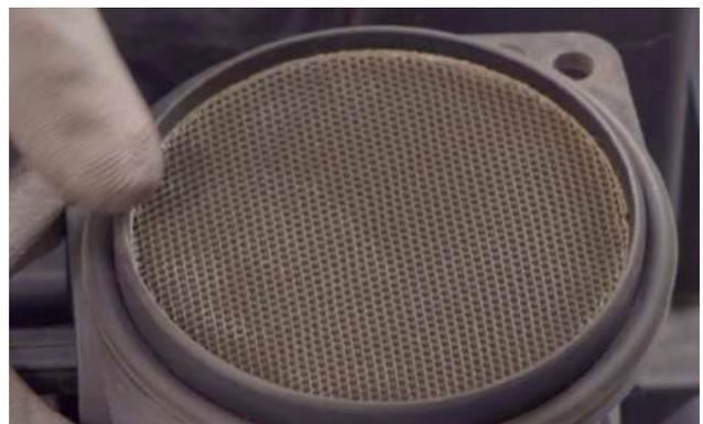
**WALKER PRODUCTS RACCOMANDA DI NON UTILIZZARE PULITORI SPRAY AD AEROSOL PER IL CONDOTTO DELL'ARIA. POSSIBILE DANNO AL SENSORE DEL FLUSSO D'ARIA.**
