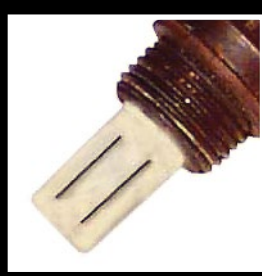
Contaminación con Silicón
