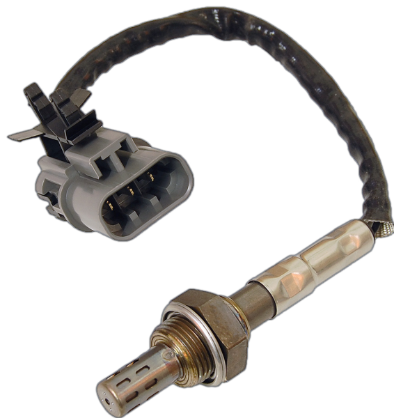
Este es un antiguo sensor HEGO (Heated Exhaust Gas Oxygen) de tres cables. El cable negro lleva la señal.
